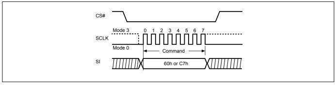
Figure 87. Chip Erase (CE) Sequence (QPI Mode)
